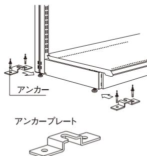
※壁面への施工は上記(壁面の芯材)を確認してタッピングやアンカーボルト等にて固定して下さい。
